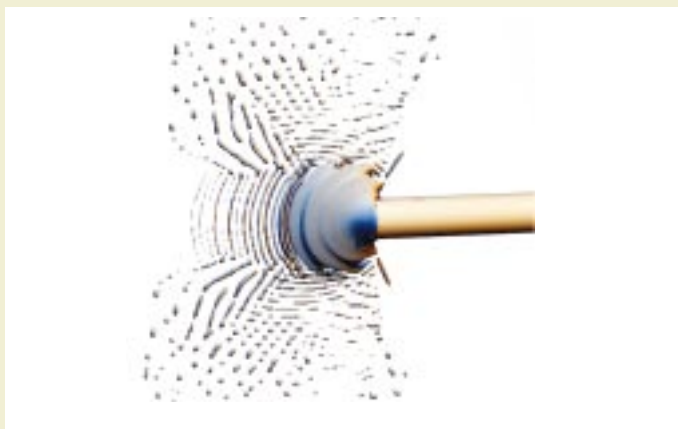
Abb. 5: Simulation der Zerstäubung eines kontinuierlichen Flüssigkeitsstrangs in einem resonanten Ultraschallfeld.
