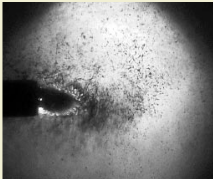
Abb. 2: Blitzlicht-Fotografie der Zerstäubung eines Flüssigkeitsstrangs im Ultraschallfeld.
