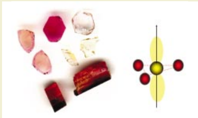
Abb. 4: Verschiedenfarbige Turmaline und der Kern des Punktdefektes, der für die gelbe Farbe verantwortlich ist. Mit gelber Farbe ist die Spindichteverteilung des ungepaarten Elektrons am Sauerstoff in der Dreiecksmittelpunkt angedeutet. Die roten Kugeln stellen Aluminiumionen ( \text{Al}^{3+} ) dar.
