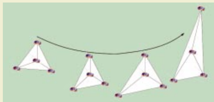
Abb. 4: Deformation einer Tetraeder-Formation beim Flug durchs All.
