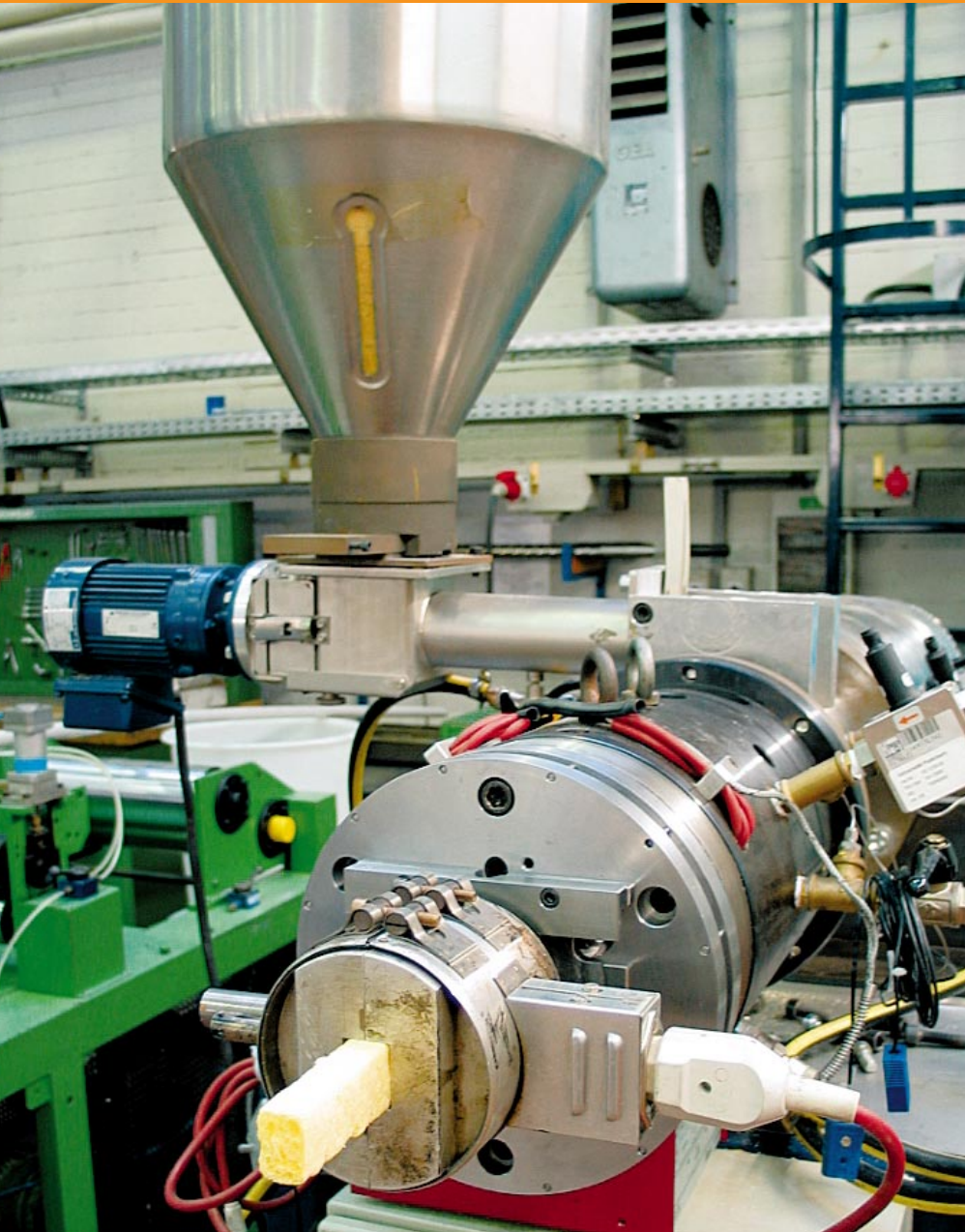
Für die Verarbeitung nachwachsender Rohstoffe wurde eigens ein Ultrakurz-Extruder entwickelt.
