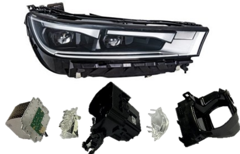
Beispielhafter Scheinwerfer (oben) und in Einzelteile zerlegtes Lichtmodul (unten) [BMW.de].
