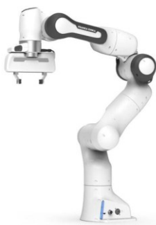
„Panda“-Roboter von Franka Emika für erste Labor-Tests und Einteichen von Bewegungsabläufen [franka.de].
